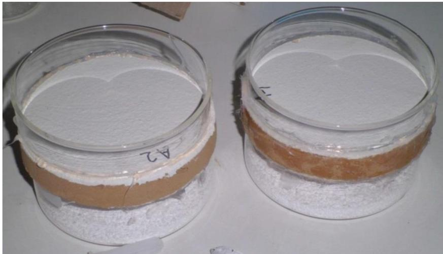
Abbildung 3.7 Versuchsbehälter Wasserdampfdiffusionswiderstand
