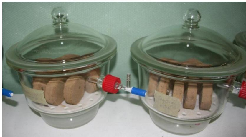
Abbildung 3.2 Versuchsdurchführung Adsorptionsisotherme
